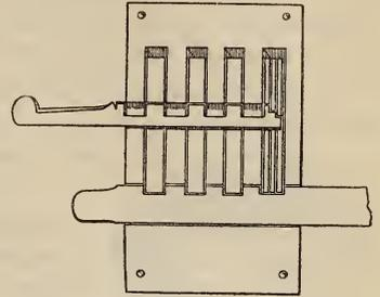
Abb. 162. Grösseres Schloss mit Schlüssel. Der Schlüssel hebt die von ihm behrührten Hölzer und macht dadurch den Riegel unter ihm beweglich.
